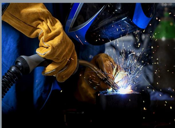
Сварочная проволока предназначена для механизированной и автоматической дуговой сварки плавящимся электродом в инертных газовых смесях изделий из высокопрочных конструкционных сталей MAGSTRONG током обратной полярности.
